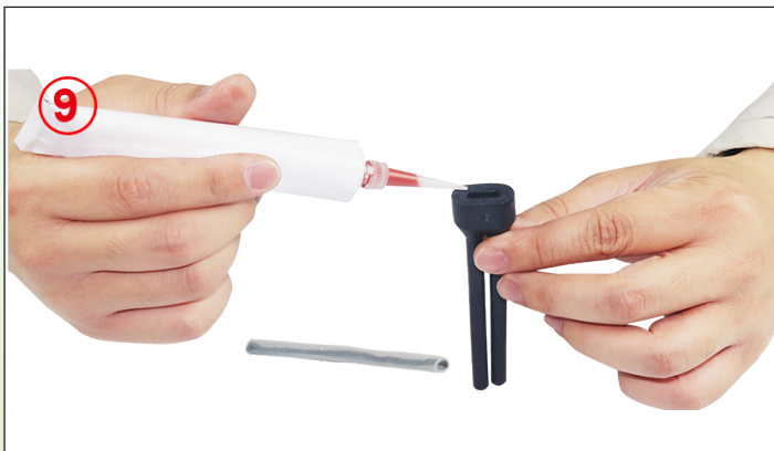
9 : Verser de la résine silicone RTV dans l'orifice principal du manchon silicone à deux orifices.
